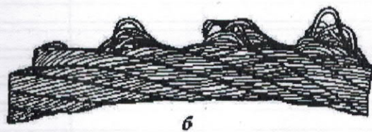
Рисунок 17 – Выдавливание проволок прядей: а — в одной пряди; б — в нескольких прядях
