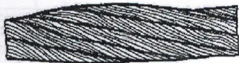
Рисунок 16 – Местное увеличение диаметра каната
